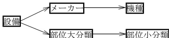
例えば設備に機関を選択した場合、機関のメーカー、そのメーカーの機種が選択され、メーカーとは無関係に機関の部位大分類とその大分類に属する部位小分類が選択され、それらに所属する部品が表示されます。
