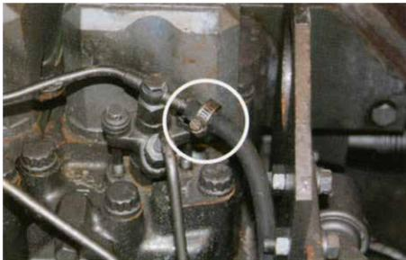
◎燃料噴射弁戻りパイプの管接手ボルトの締付時は、本体側（燃料噴射弁）と共廻りしていないことを確認する！！
