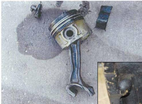
コン・ロッド大端部の固定ボルトが脱落(折損)して
