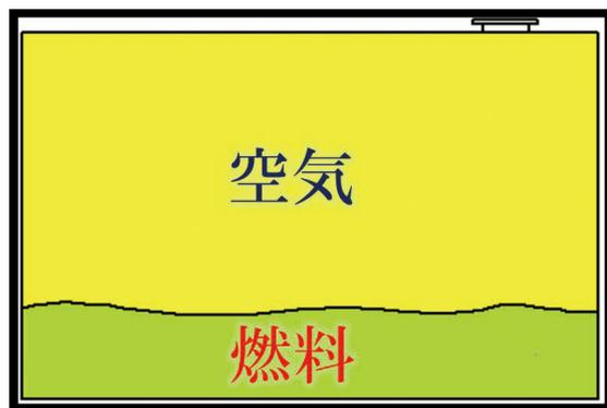
戻り燃料（温度が高い）によりタンク内温度が上がる
