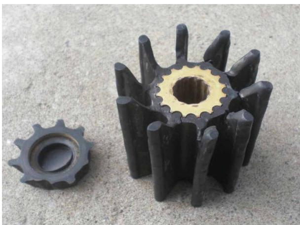
羽根が損傷したインペラ
